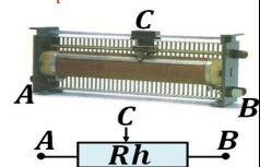
Remarque: Le rhéostat est utilisé dans un circuit électrique soit pour varier le courant passant dans le circuit lorsqu'il est branché en série avec les autres composants, soit pour varier la tension lorsqu'il est utilisé comme diviseur de tension (en parallèle) entre les bornes d'un dipôle.
