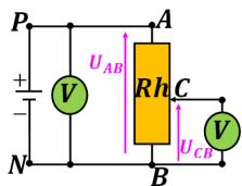
b- Déterminer le domaine de variation de la tension  $U_{CB}$ lorsqu'on déplace le **glisseur** C vers les deux **bornes**.
